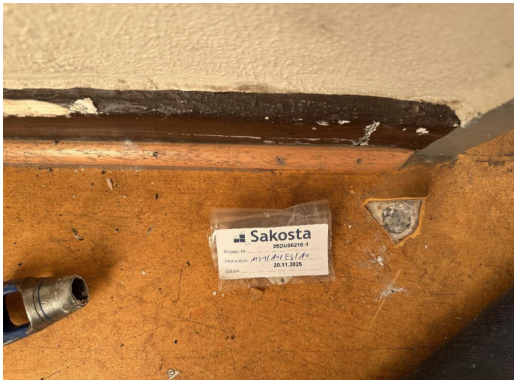
Bild 10 : PVC-Kleber(Schwarz) und Ausgleichmasse unter Orange PVC- Bodenbealg ist Asbesthaltig Proben: M21/A1/EG/A1 und M73/A1/EG/Selmizimmer sowie den früheren Schadstoffuntersuchungsberichten (WESSLING GmbH, 05/2013).
